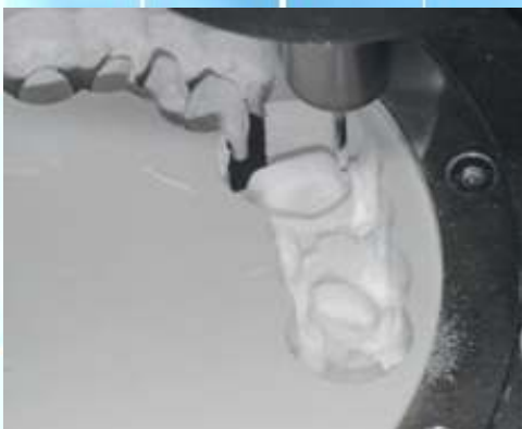
Fräsen von Zirkonoxidblanks
